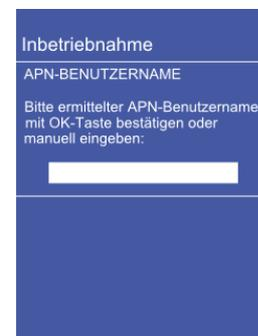
SIM-PIN und APN-Zugangsdaten eingeben
